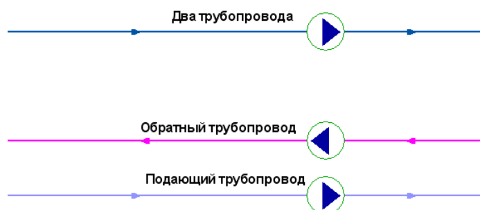
Рис. 3.4. Пример отображения насосной станции.
